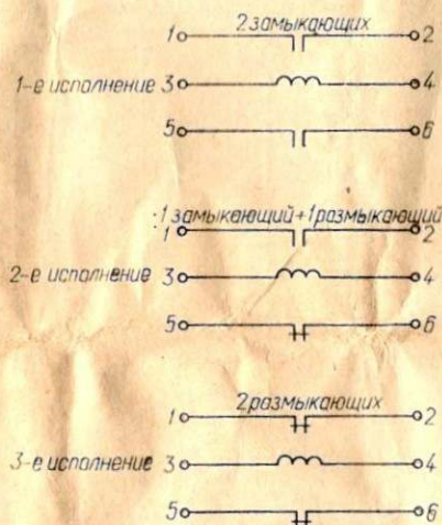
Рис. 3. Схема исполнений контактной системы блоков сигнальных реле типа СЭ-4УЗ
